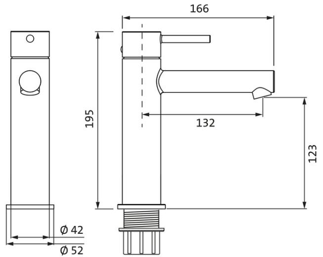
Lochbohrung  $\varnothing$  35 mm
