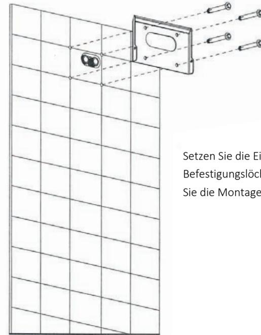
Setzen Sie die Einschlaganker in die Befestigungslöcher und montieren Sie die Montageplatte.
