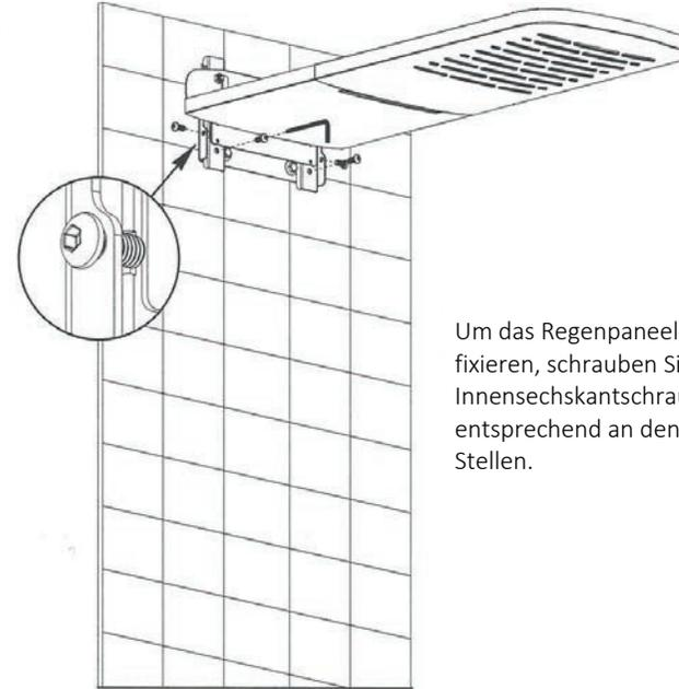
Um das Regenpaneel zu justieren und zu fixieren, schrauben Sie die vier M6 Innensechskantschrauben der Abbildung entsprechend an den vorgesehenen Stellen.
