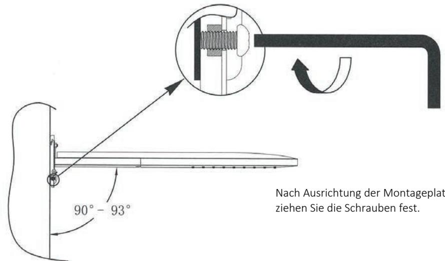
Nach Ausrichtung der Montageplatte, ziehen Sie die Schrauben fest.
