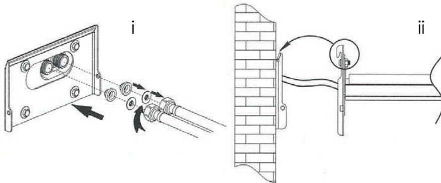
Setzen Sie die G1/2" Siebdichtungen auf die Gewindehülsen und die Durchflussbegrenzer in die G1/2" Flex-Schläuche.
