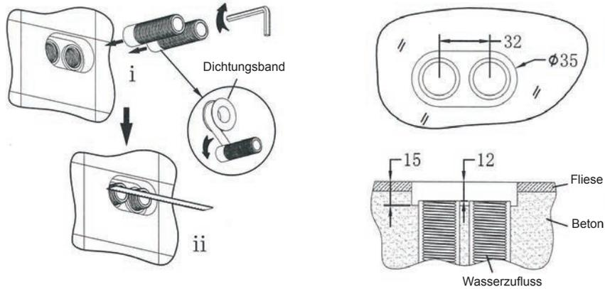
Entnehmen Sie die G1/2" Gewindehülsen aus der Verpackung und installieren Sie diese der Abbildung entsprechend an den Anschlüssen. Stellen Sie sicher, dass die Gewindehülsen bündig mit der Wand abschließen.
