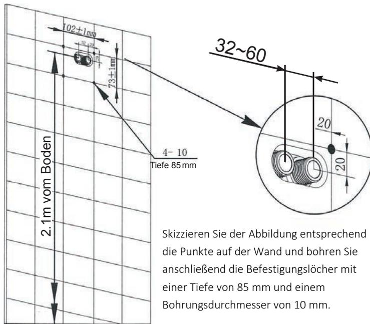
Skizzieren Sie der Abbildung entsprechend die Punkte auf der Wand und bohren Sie anschließend die Befestigungslöcher mit einer Tiefe von 85 mm und einem Bohrungsdurchmesser von 10 mm.
