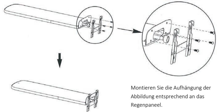
Montieren Sie die Aufhängung der Abbildung entsprechend an das Regenpaneel.
