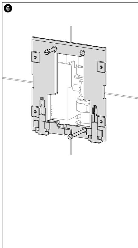
Montagerahmen mit den Befestigungsschrauben ausrichten und montieren.
