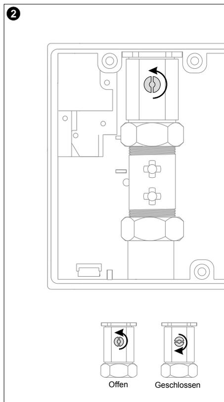
Kugelhahn der Vorabsperung öffnen und Leitung gründlich durchspülen. Anschließend Kugelhahn wieder schließen!
