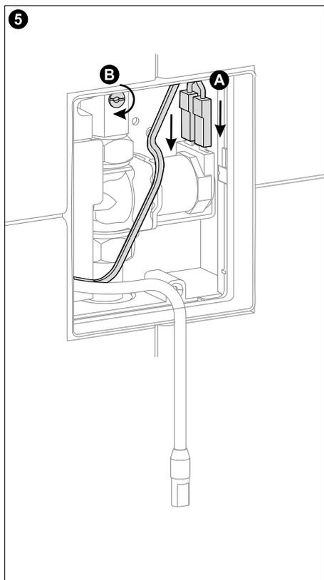
(A) Steckzungenkontakte auf Magnetventilspule aufstecken.
