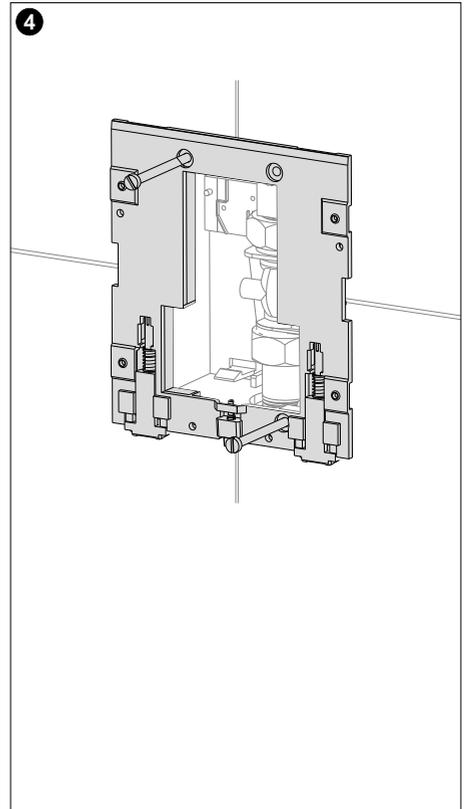
(A) Verschraubungen am Zwischenrohr lösen und Zwischenrohr und Dichtungen entfernen.
