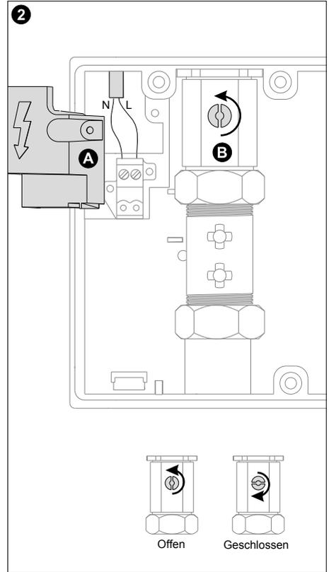
(A) Klemmenabdeckung öffnen und Netzanschluss herstellen. Klemmenabdeckung wieder aufsetzen.
