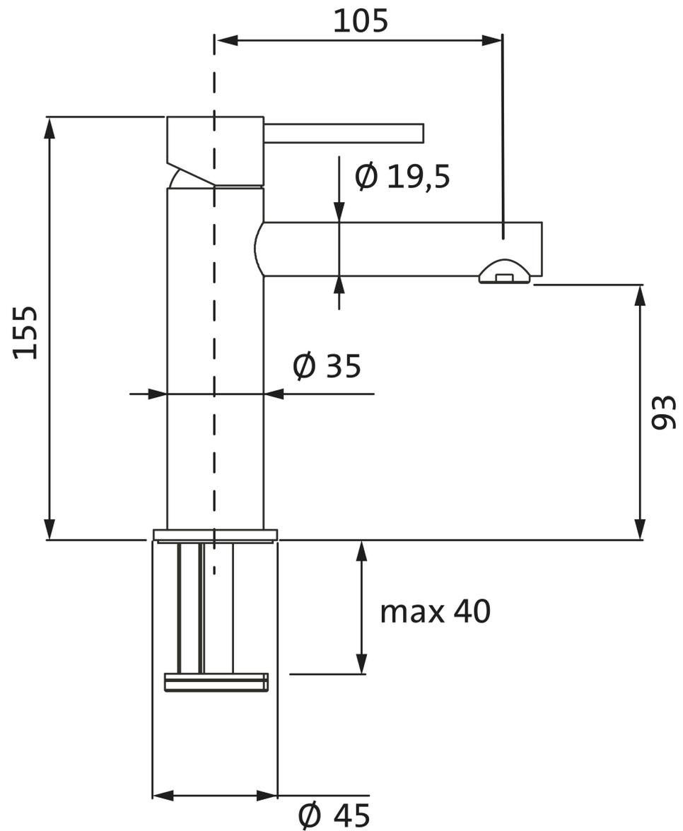
Lochbohrung  $\text{Ø } 35$  mm
