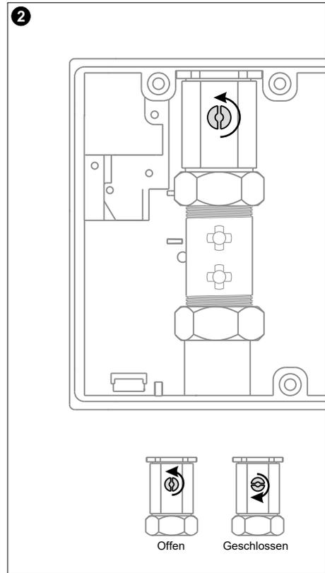
Kugelhahn der Vorabspernung öffnen und Leitung gründlich durchspülen. Anschließend Kugelhahn wieder schließen!
