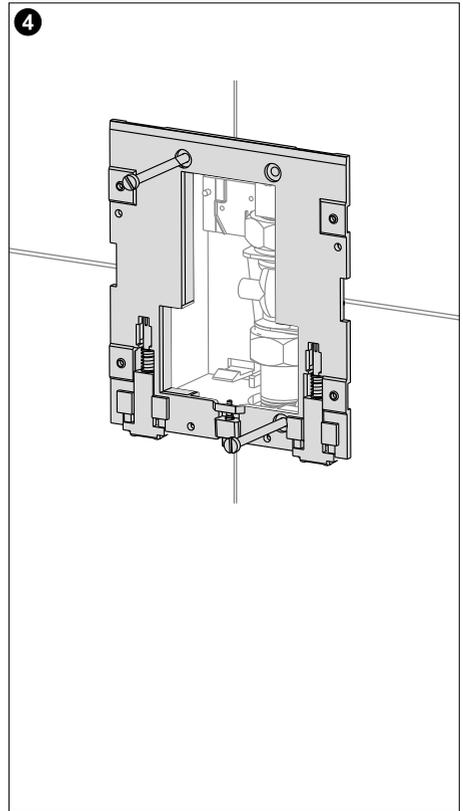
Montagerahmen mit den Befestigungsschrauben ausrichten und montieren.
