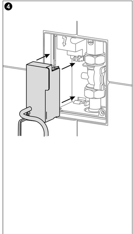
Elektronikmodul einsetzen, auf die Steckkontakte schieben und einrasten lassen.
