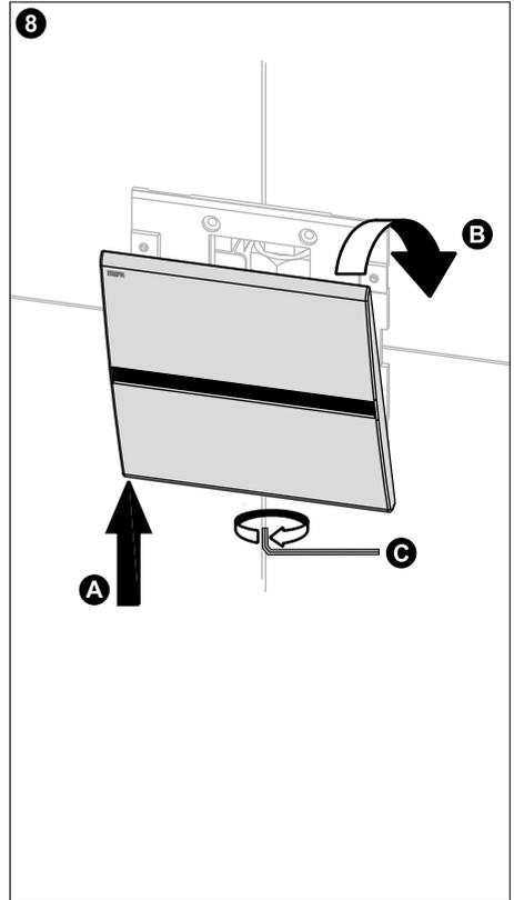
Edelstahlfrontplatte auf den Montagerahmen unten aufsetzen (A) und dann nach oben einrasten (B).
