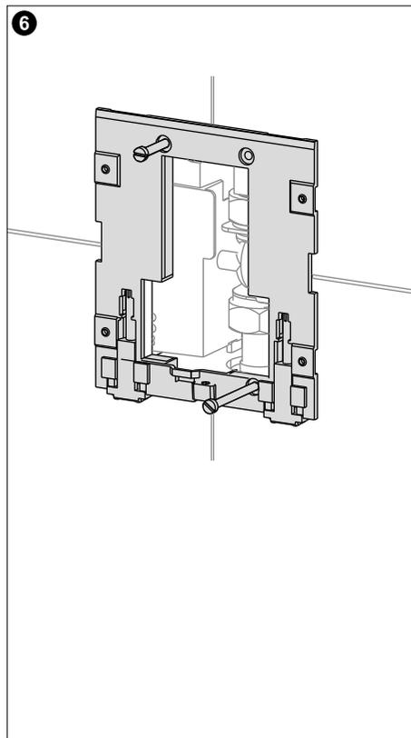
Montagerahmen mit den Befestigungsschrauben ausrichten und montieren.
