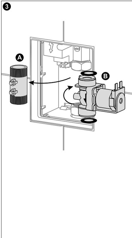
(A) Verschraubungen am Zwischenrohr lösen und Zwischenrohr und Dichtungen entfernen.
