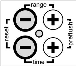
Taste "range-" und Taste "time-" gleichzeitig für 3 Sekunden drücken. Nach dem Reset leuchtet die LED 3x auf.
