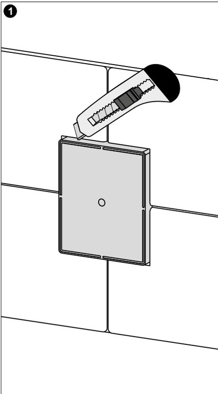
Bauschutzdeckel sauber mit einer scharfen Klinge an den Kanten aufschneiden und entfernen.
