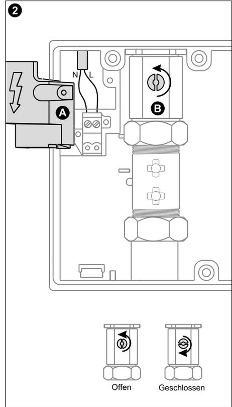
(A) Klemmenabdeckung öffnen und Netzanschluss herstellen.
