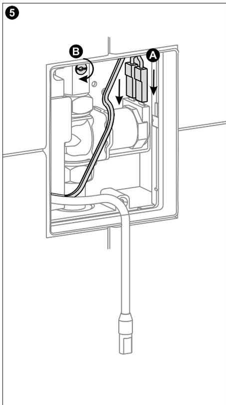
**(A)** Steckzungenkontakte auf Magnetventilspule aufstecken.
