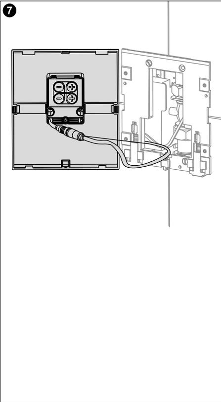
Sensordatenkabel der Elektronik mit dem Kontaktstecker der Frontplatte verbinden.
