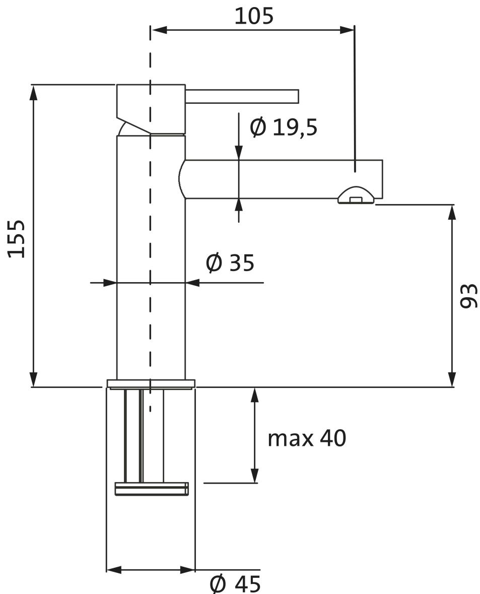
Lochbohrung  $\varnothing 35$  mm
