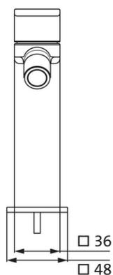
Lochbohrung  $\varnothing$  35 mm
