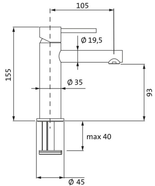
Lochbohrung Ø 35 mm
