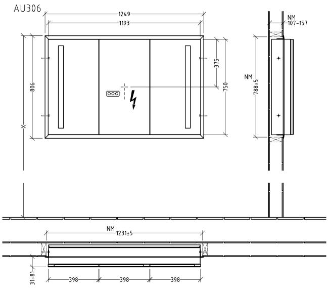
$N \stackrel{\perp}{=} L_{_1}$  220 - 240 V loser Netzanschluss ( laut VDE 0100 Teil 701 )
