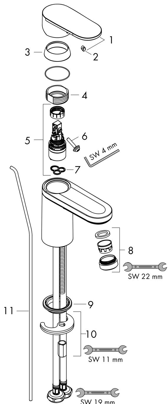
**Vernis Blend****Einhebel-Waschtischmischer 70 mit isolierter Wasserführung und Zugstangen-Ablaufgarnitur**Oberfläche: **Chrom** Artikelnummer: **71570000**
