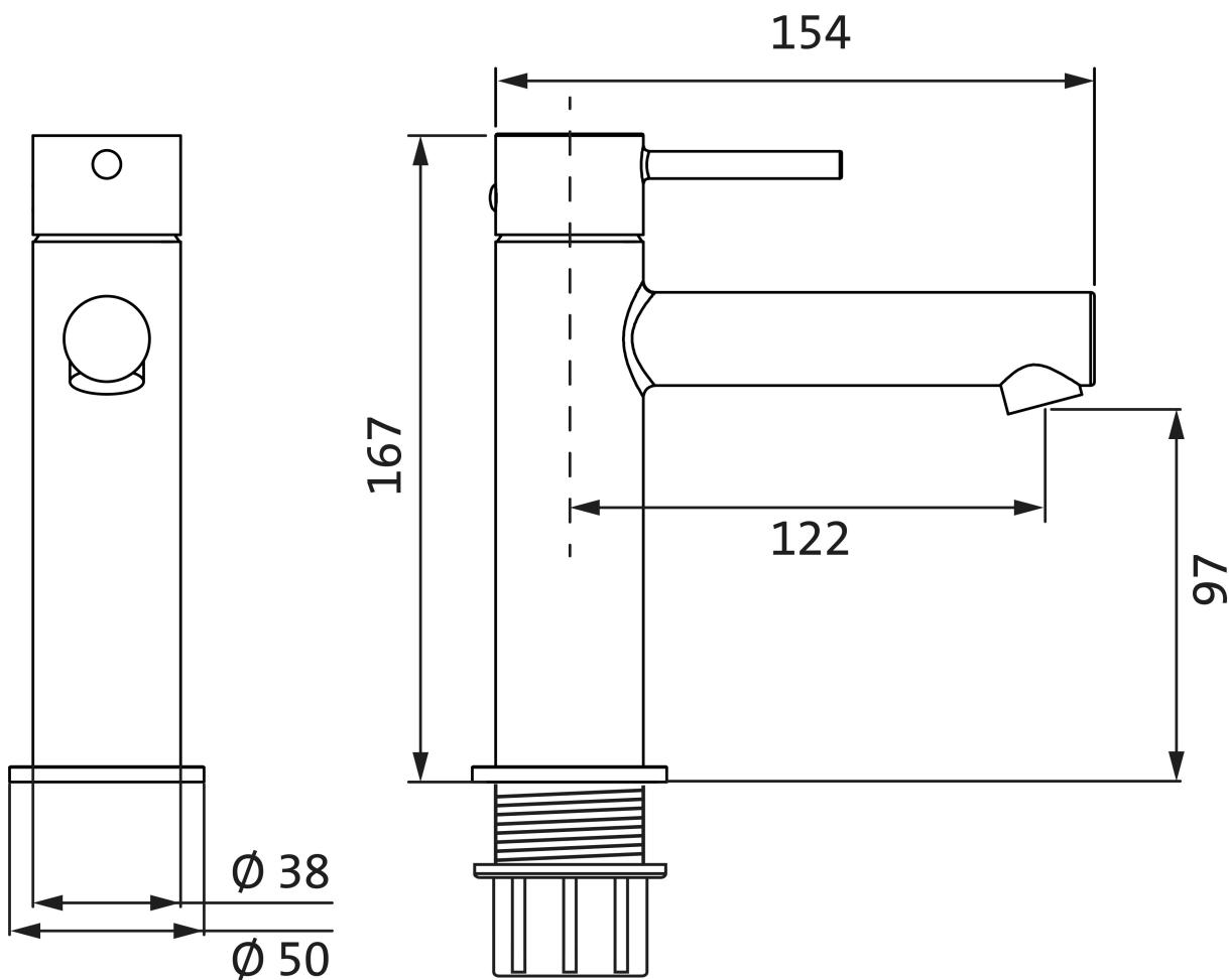
Lochbohrung Ø 35 mm
